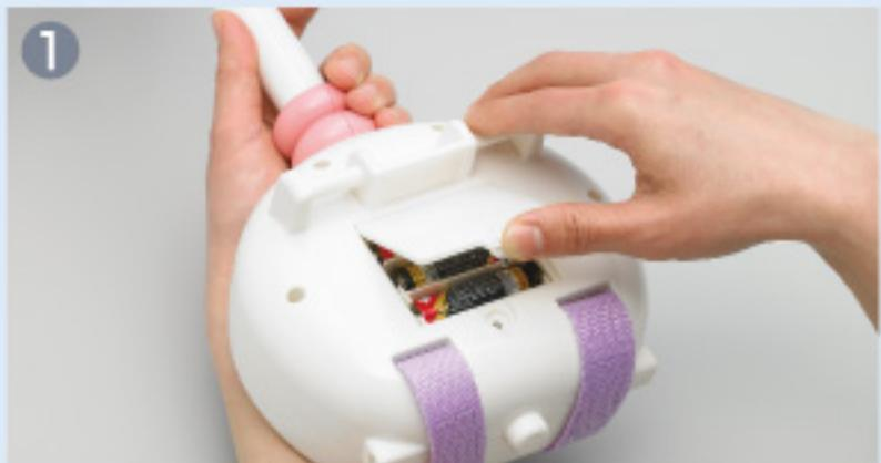
電池ケースの蓋を(+)ドライバーで外し、電池を $\oplus\ominus$ を間違えないようにセットします。
