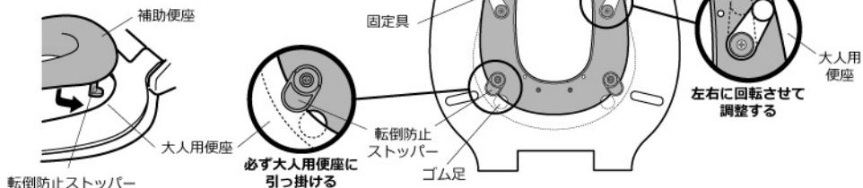
※取付の際、大人用便座の一番後方にあわせて取り付けてください。お子さまが座った際に洗浄水がお尻にあたるようになっています。（座り方によって洗浄水のある場所はことなりますので、お尻を移動して調整してください。）
