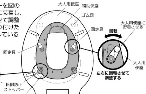
\*取付の際、大人用便座の一番後方にあわせて取り付けてください。お子さまが座った際に洗浄水がお尻にあたるようになっています。(座り方によって洗浄水のあたる場所はことなりますので、お尻を移動して調整してください。)
