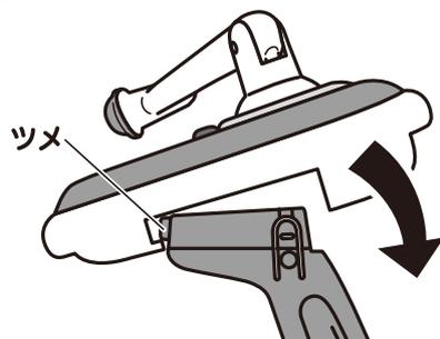
図を参考に本体底面の前側の穴をスタンド左右ツメ部分に差し込んでから本体を下にパチッと音がするまで押し下げます。
